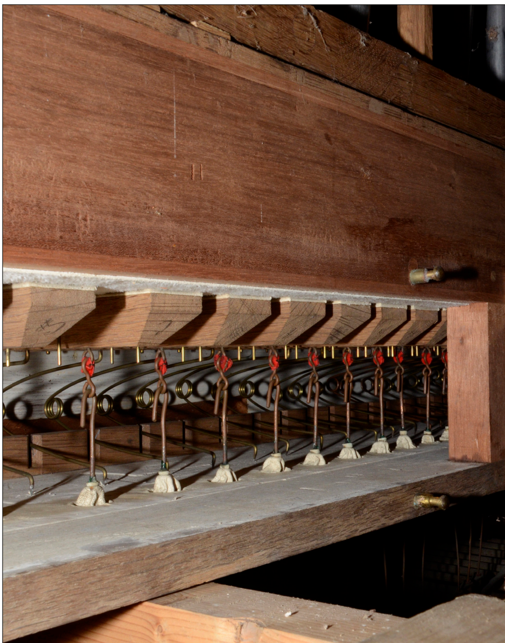
De ventielen van het orgel in Kloosterburen zijn gemaakt van eikenhout. Op de voorkanten in handschrift de toonnamen.
