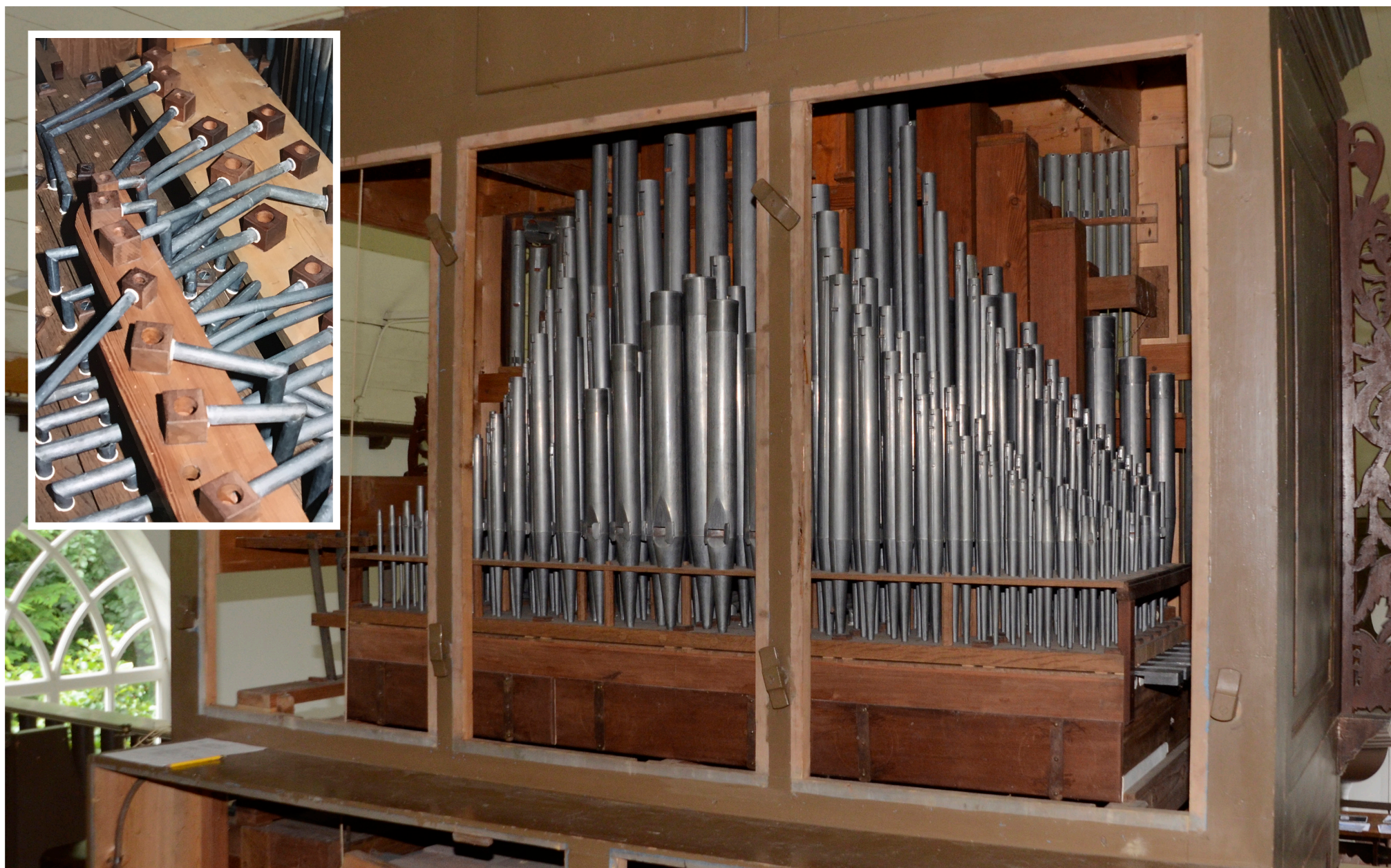
De windlade van het orgel; vooraan de Fluit 4', waarvan de 12 grootste pijpen gedekt zijn. De inzet (foto tijdens de restauratie gemaakt door Stef Tuinstra) toont de twee banken. De foto toont links onderin mooi hoe Van Oeckelen de grootste 12 pijpen van de Holpijp vanaf twee plaatsen 'aanstuurde': vanaf de stok van de Holpijp zelf, en vanaf die van de Viola di Gamba.
